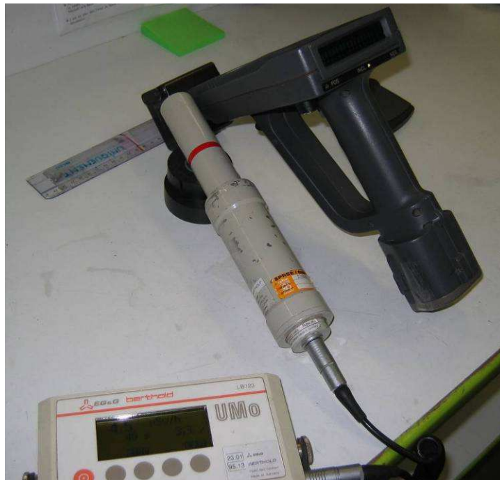
Photo 1 : mesure de débit d'équivalent de dose sur le flanc gauche du détecteur
